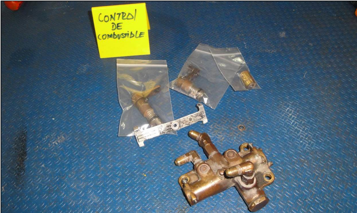
Control de combustible del motor Continental IO-520D
