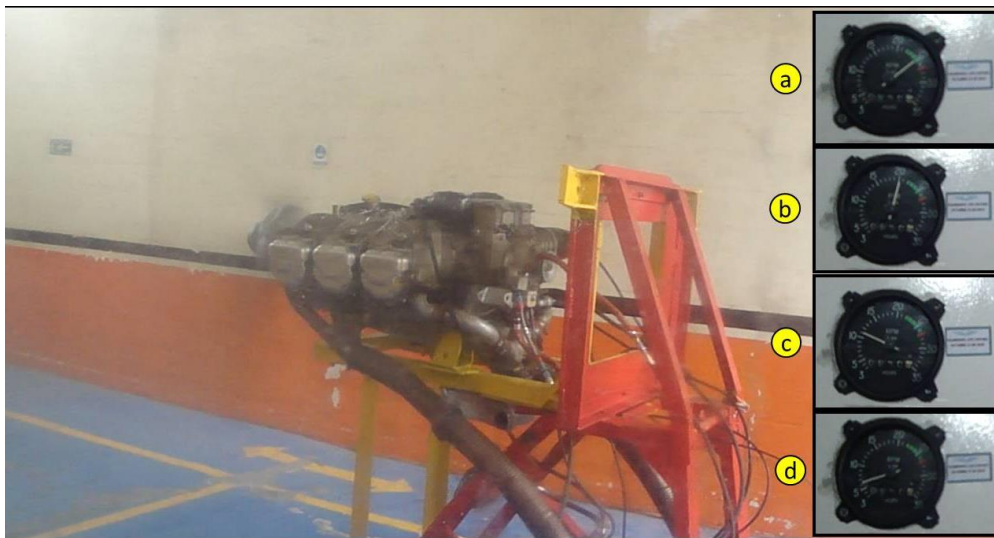
Pruebas de potencia con mezcla rica en el motor Continental IO-520-D S/N174579R
