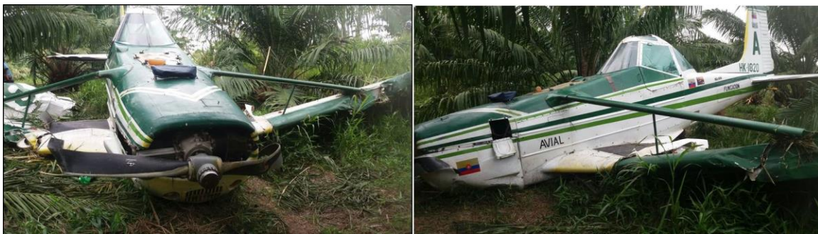
Deformación en las palas de la hélice (Izq.) y fractura de los trenes de aterrizaje (Der.)
