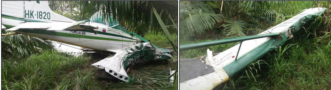
Daños sufridos en los planos de la aeronave
