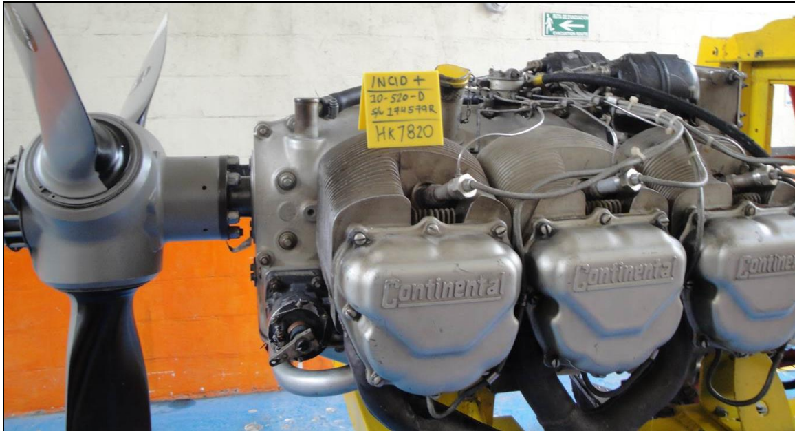
Motor Continental IO-520D S/N174579R en banco de pruebas
