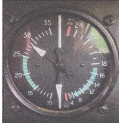
Instrumento indicador de presión del manifold (Izq.) y flujo de combustible (Der.)
