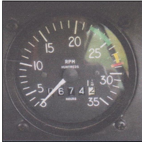
Instrumento indicador de revoluciones del motor (Tacómetro)
