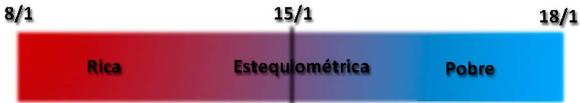
Relación de mezcla de combustible en el motor de cuatro tiempos
